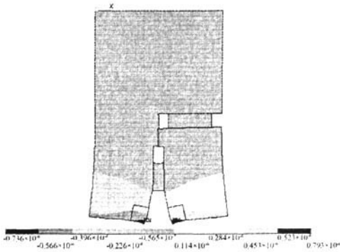
图 5 EPU100 横梁水平方向变形
